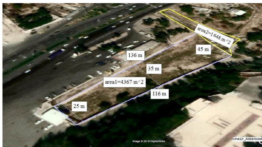
Fig. 2- Dimensions of water accumulation pool (Beitollahi et al., 2019) شکل ۲- ابعاد استخر تجمع آب (Beitollahi et al., 2019)
