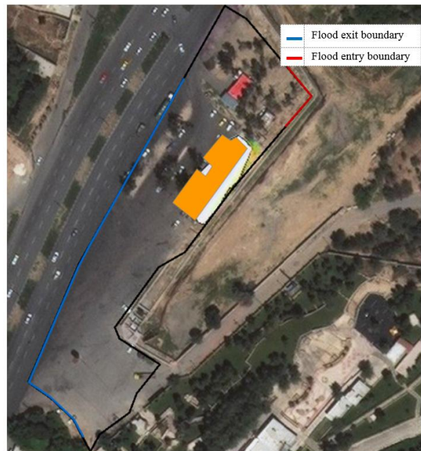
Fig. 7- Flood entry and exit boundaries for the parking lot in two-dimensional hydraulic simulation شکل ۷- مرز ورود و خروج سیلاب از پارکینگ در شبیه‌سازی دوبعدی هیدرولیکی
