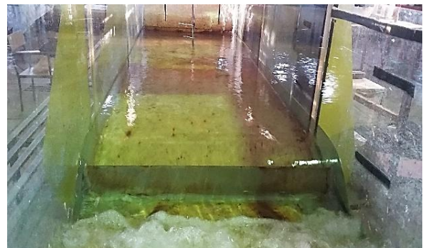
Fig. 1- Designed rectangular weir in the flume شکل ۱- سرریز مستطیلی شکل طراحی شده در فلوم
